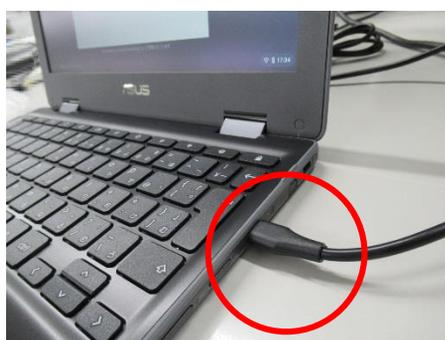
図3-5 ACアダプタ挿し口
