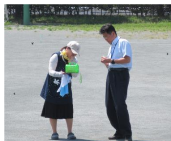
WBGT計による計測
